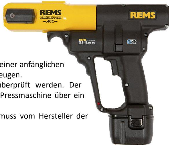
Diese Maschinen sind so eingestellt, dass sie mit einer anfänglichen Kraft von 36 KN eine Presskraft von 100 KN zu erzeugen. Alle Pressmaschinen müssen vom Hersteller überprüft werden. Der Nutzer muss sicherstellen, dass die verwendete Pressmaschine über ein Prüfprotokoll verfügt. Die Verwendung einer anderen Pressmaschine muss vom Hersteller der DiaSafe Systeme genehmigt werden.
