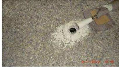
Im Kegel eingebetteter Systemhalter hat sich wie geplant gedehnt und der Kegel reißte entlang der unteren horizontalen Sollbruchstelle.
