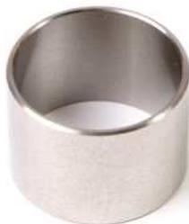
Dieser Edelstahlring mit Innen- $\varnothing$  28.5 mm fixiert den Befestigungskopf und verhindert während der Seilmontage und des Anziehens der Madenschraube ein Auseinanderspreizen des Befestigungskopfes.
