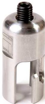
Eine aus Edelstahl gefertigte Bajonettkonstruktion am Kopf des Systemhalters hat die Aufgabe, das Edelstahlseil mit der Haltesäule zu verbinden. Die Befestigung erfolgt durch Madenschraube (4-6 Nm)
