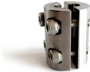
Die Pressbacken-Nuss wird bei der Endbefestigung des Seils in einem DiaSafe - System verwendet. Am Seilende wird eine Schlaufe mit einer Pressbacken-Nuss geformt. (Mindest- Drehmoment  $\geq 7$  Nm).
